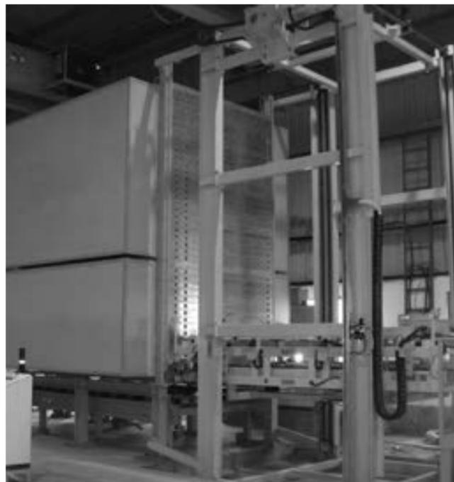
Il magazzino o forno versione combinata (per l'asciugatura e la catalisi di resine), per lastre di marmo e granito permette l'asciugatura e la catalisi delle resine, attraverso un sistema di riscaldamento a ricircolo d'aria forzata e gruppi termici, alimentate secondo il modello elettricamente o a gas; le due sezioni del forno rispettivamente di asciugatura e di catalisi sono indipendenti e controllate separatamente.
