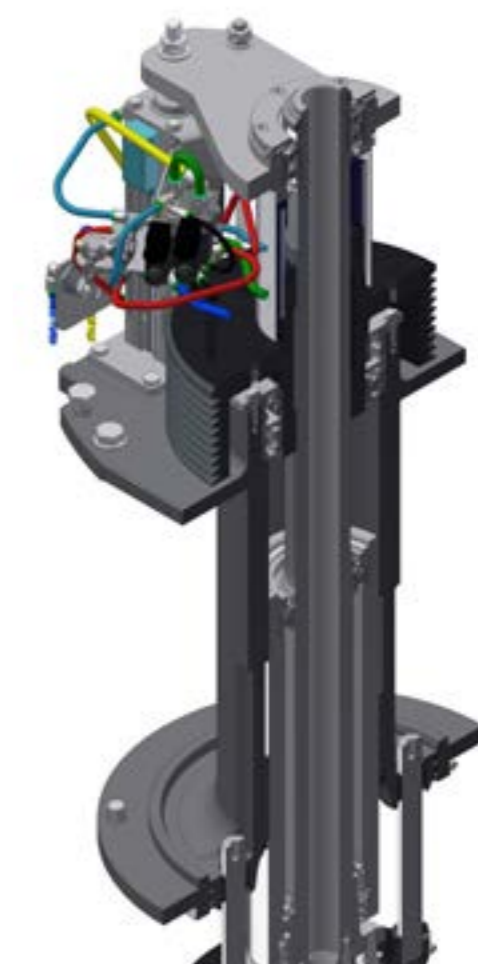
Particolare valvola proporzionale - cilindro con encoder Detail of the proportional valve – cylinder with encoder
