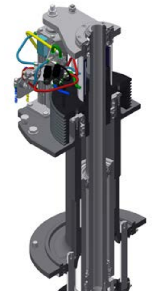
Particolare valvola proporzionale - cilindro con encoder Detail of the proportional valve – cylinder with encoder
