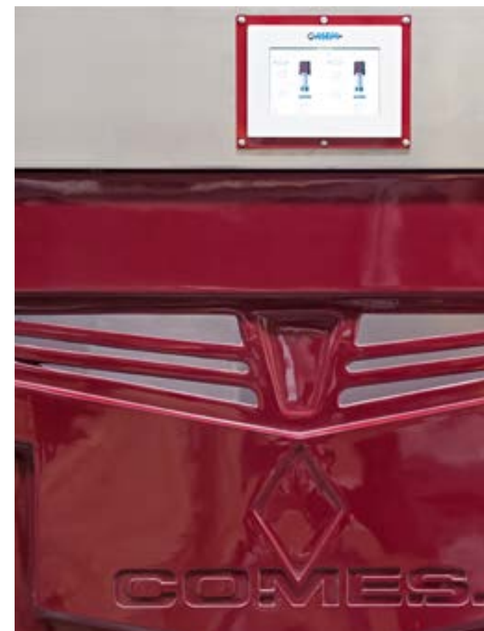
Particolare quadro di comando generale e singolo mandrino Detail of the master control panel and single spindle
