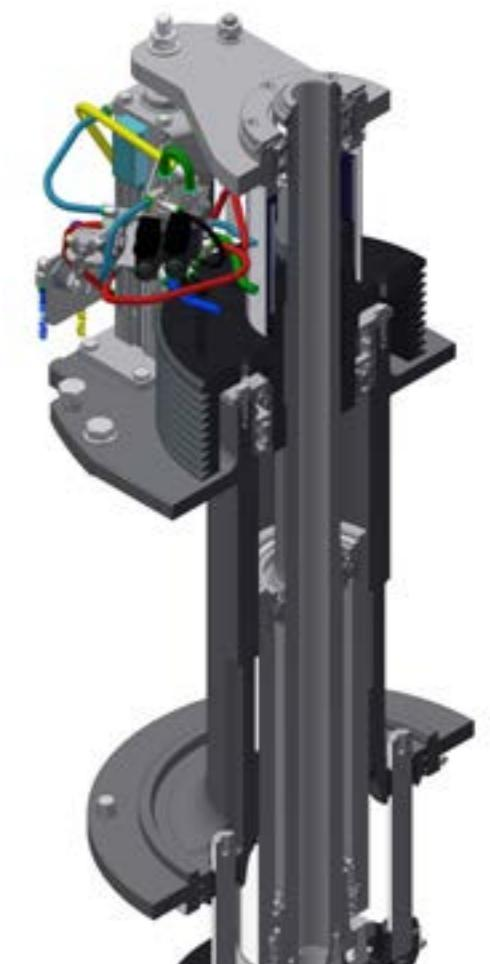
Detalle de la válvula proporcional - cilindro con codificador
